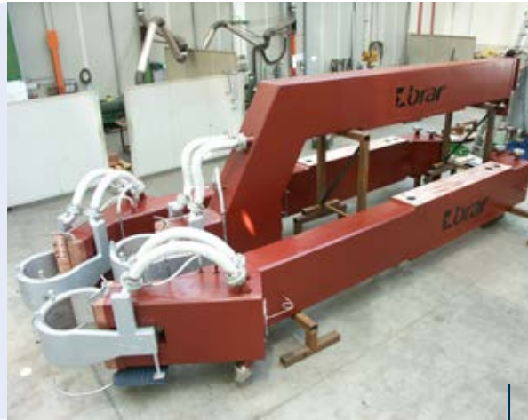
Bracci bimetallo rame-acciaio / Copper-steel bimetallic arms
